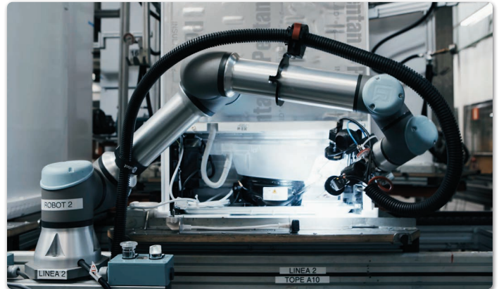
Ein KI-gesteuerter Roboter prüft Kühlschränke auf austretendes Kältemittel. Die KI-Vision-Software führt den Robotern verlässlich an die zu prüfenden Lötstellen.
