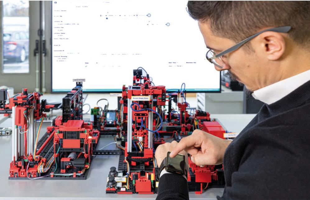
Intelligente Algorithmen erkennen Fehler und Verschleißerscheinungen und die Smart Watch verrät dem Maschinenbediener, wie er die Störungen beheben kann: Ein Forschungsteam vom Fraunhofer IPA hat zusammen mit Partnern aus der Industrie eine Methode entwickelt, wie Künstliche Intelligenz in die Instandhaltung integriert werden kann.
