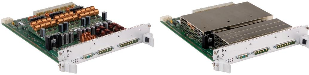
**Bild 4: Dreifachausgänge, mehrphasig, PRBX-Coreless-Stromversorgung zur Aufrechterhaltung des B0-Feldes**
