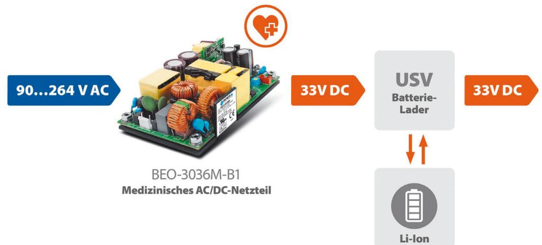
**Das lüfterlose AC/DC-Medizin-Netzteil BEO-3036M-B1 von Bicker Elektronik versorgt die mobile Energieversorgungseinheit mit exakt geregelten 33 VDC.**
