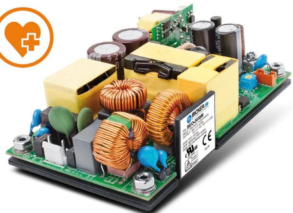
**Das lüfterlose AC/DC-Medizin-Netzteil BEO-3036M-B1 von Bicker Elektronik ist für den internationalen Einsatz mit einem Weitbereichseingang 90...264VAC und aktiver PFC ausgestattet.**
