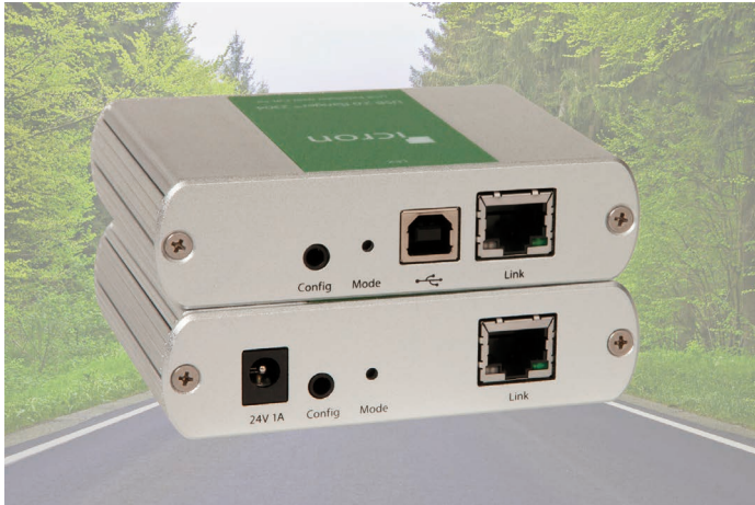
Bild 2: Ranger 2304 USB-Extender, Link-Seite. Über die beiden Link-Ports werden LEX (oben) und REX (unten, mit Anschluss für Versorgung) per Ethernet-Kabel direkt verbunden.
