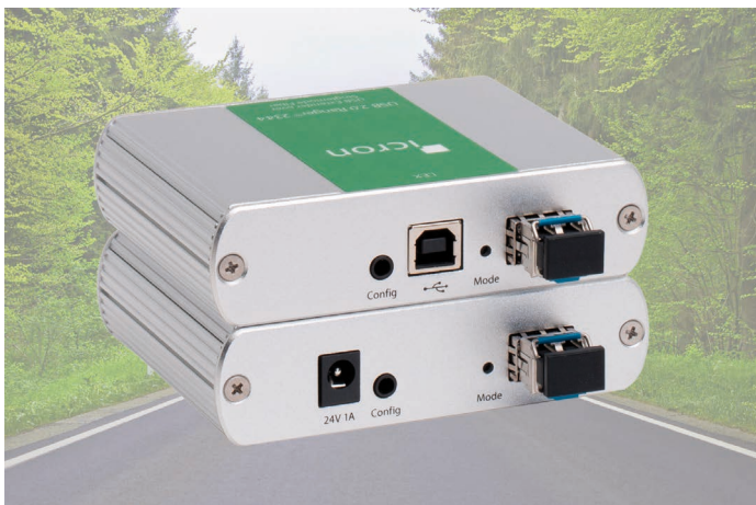
Bild 4: Ranger 2344 USB-Extender, Link-Seite (über die beiden Link-Ports werden LEX (oben) und REX (unten, mit Anschluss für Versorgung) per Singlemode-LWL-Kabel direkt verbunden)
