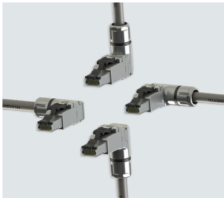
Bild 2: Feldmontierbare RJ45-Stecker, deren Kabelabgang vor Ort festgelegt und auch nachträglich geändert werden kann, sind besonders praxisfreundlich. Im Bild: Der MFP8 4x90 von Telegärtner Produktfotos © Telegärtner
