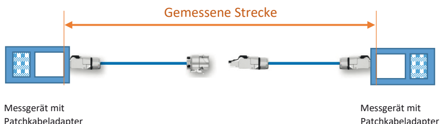
Bild 9: Für die korrekte Messung eines kompletten End-to-End Links werden Messgeräte mit Patchkabeladapter benötigt.
