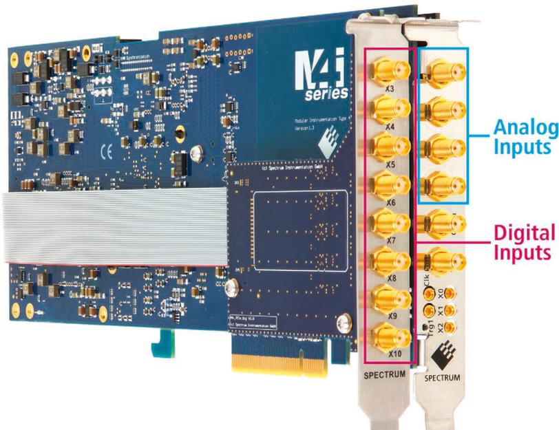
**Bild 1:** Das Zusatzmodul DigSMA fügt einem Digitizer der M4i.44xx-Serie acht digitale Eingangskanäle hinzu.
