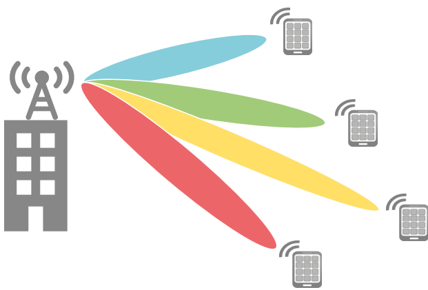
Bild 2: Im MU-MIMO-Modus verwenden mehrere UEs dieselbe Zeit-/Frequenzressource im Raummultiplexverfahren.
