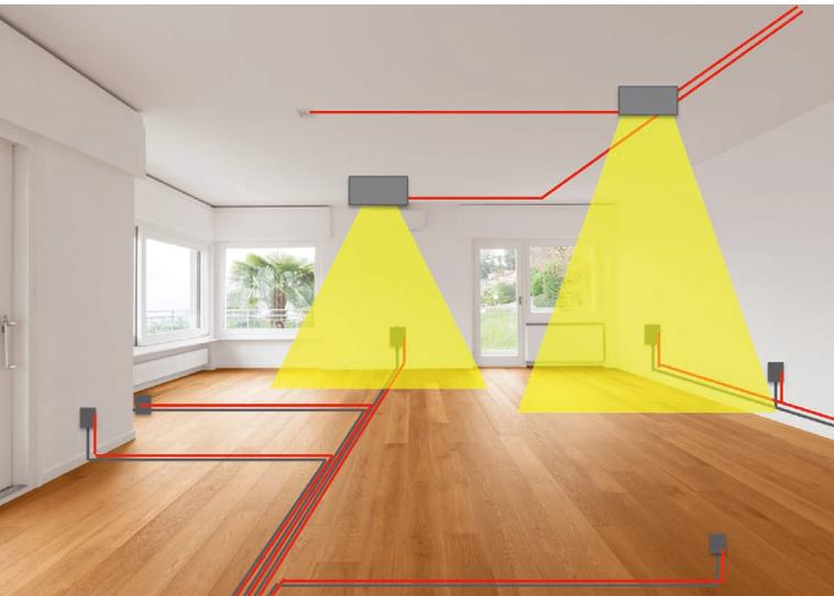
Um LiFi z.B. an der Decke oder in Lampen optimal mit Daten zu versorgen, braucht es eigene Datenleitungen zu den Lichtauslässen.
