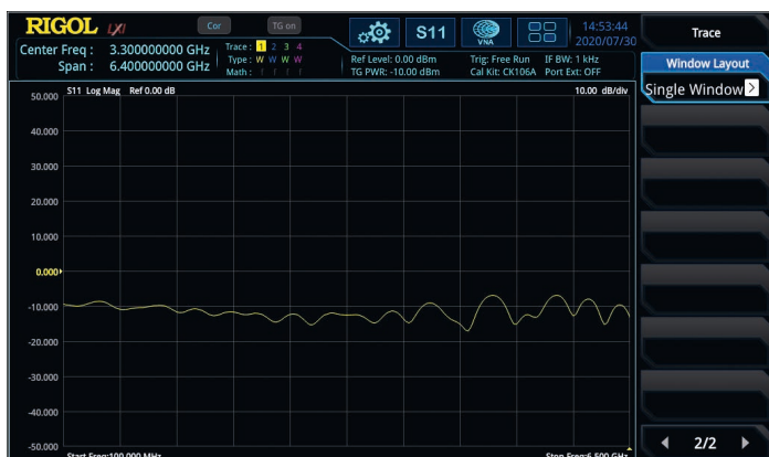
Bild 8: S11 logarithmisch (li.) und DTF-Zeitansicht der identischen Komponente (re.)
