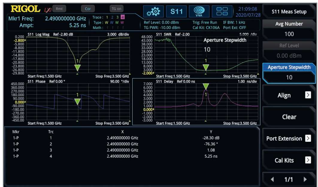
Bild 5: S11-Messung, logarithmische Größen vom Betrag r , Phasengang, SWR und Gruppenverzögerung über der Frequenz
