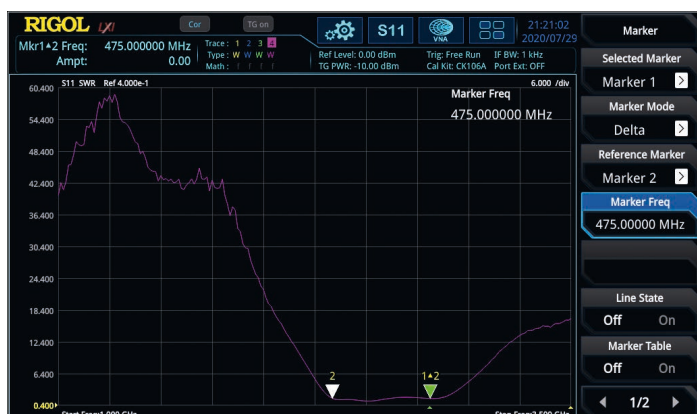
Bild 6: S11-Messung (li.) und Messung von S21 (Durchgangsdämpfung) in dB (re.)
