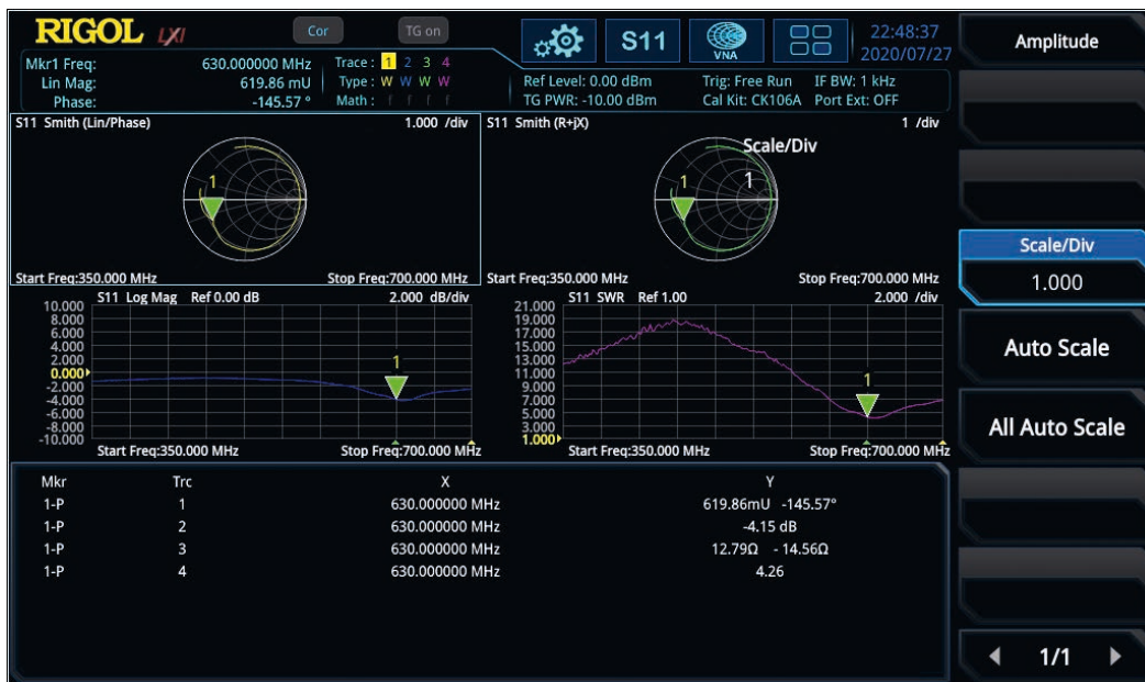
Bild 4: Verschiedene Fenster der S11-Parameter wie Smith und Polarebene, Rückflussdämpfung in dB und SWR
