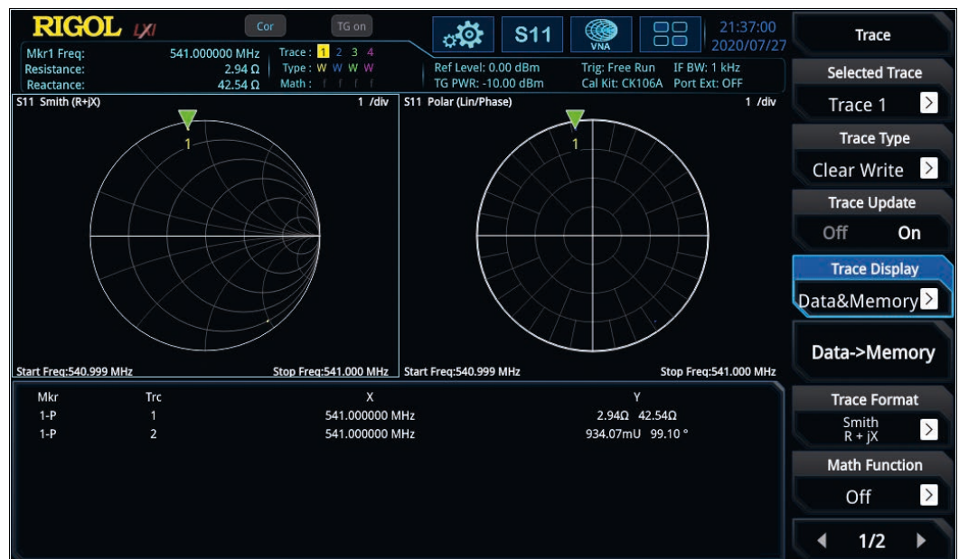
Bild 2: Zur Messung der Kapazität in Reihe mit einem Widerstand bei 541 MHz
