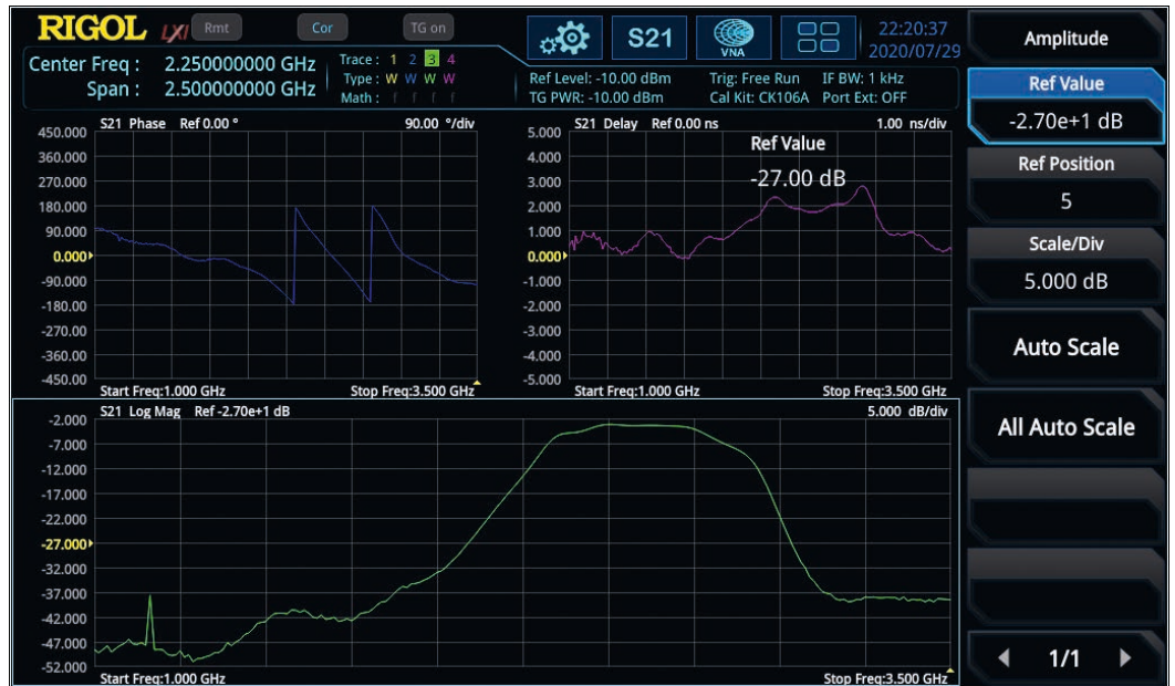
Bild 7: S21-Messung mit Durchgangsdämpfung (grün), Phase (blau) und Gruppenlaufzeit (pink)
