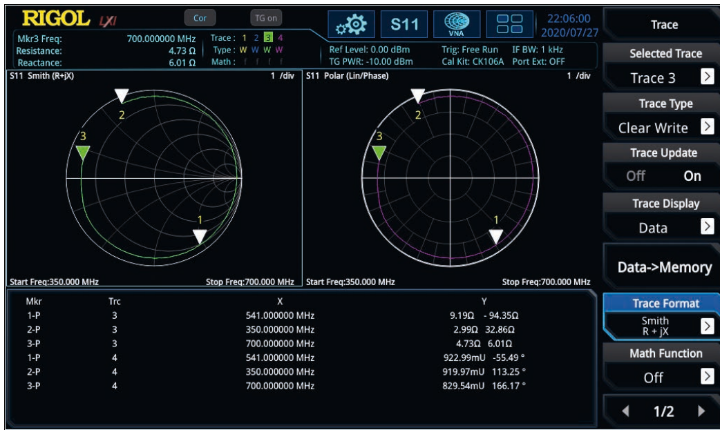
Bild 3: Frequenzgangkurve; die Frequenz steigt im Uhrzeigersinn an
