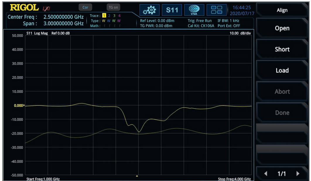
Bild 10: S11-Messung eines Bandpassfilters vor (dünne Linie) und nach (dicke Linie) Kalibrierung eines Ports
