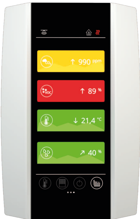
Zwei All-in-One-Raumbediengeräte mit Erfassung verschiedenster Messwerte: Novos Touch und thanos EVO von Thermokon
